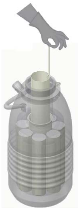
Rysunek 1: Wkładanie lub wyjmowanie kanistrów
