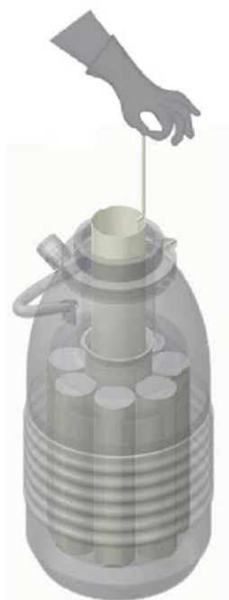
Figura 1: Inserimento o rimozione di cestelli
