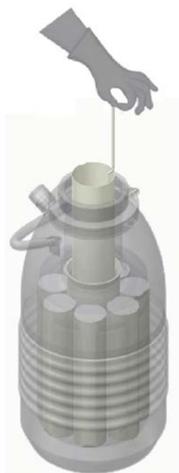
Abbildung 1: Einsetzen und Entfernen von Kanistern
