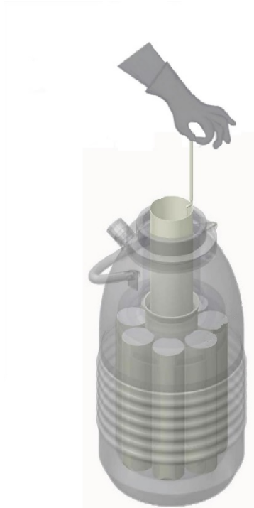
Afbeelding 1: Inbrengen of verwijderen van houders
